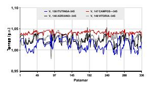
Figura 12 – Perfil de tensão da malha de 345 kV
