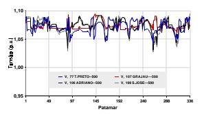
Figura 11 – Perfil de tensão da malha de 500 kV
