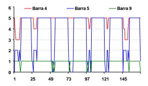
Figura 7 – Evolução do chaveamento dos bancos de capacitores durante a simulação da curva de carga
