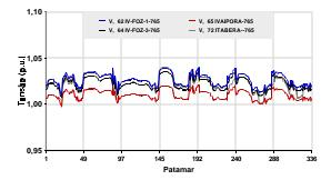
Figura 10 – Perfil de tensão da malha de 765 kV
