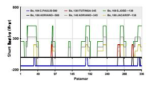
Figura 15 – Evolução do chaveamento de bancos shunt para controle de tensão da malha de transmissão da área Rio de Janeiro / Espírito Santo
