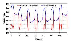
Figura 5 – Perfil de tensão da barra 5
