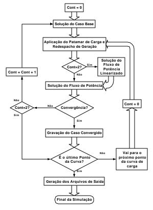
Figura 1 – Estrutura básica da simulação da curva de carga
