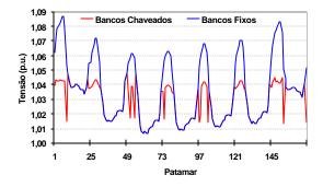
Figura 6 – Perfil de tensão da barra 9
