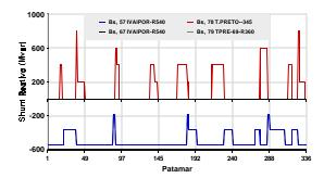
Figura 14 – Evolução do chaveamento de bancos shunt para controle de tensão da malha de 765 kV
