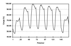
Figura 3 – Curva de carga aplicada ao sistema IEEE-14
